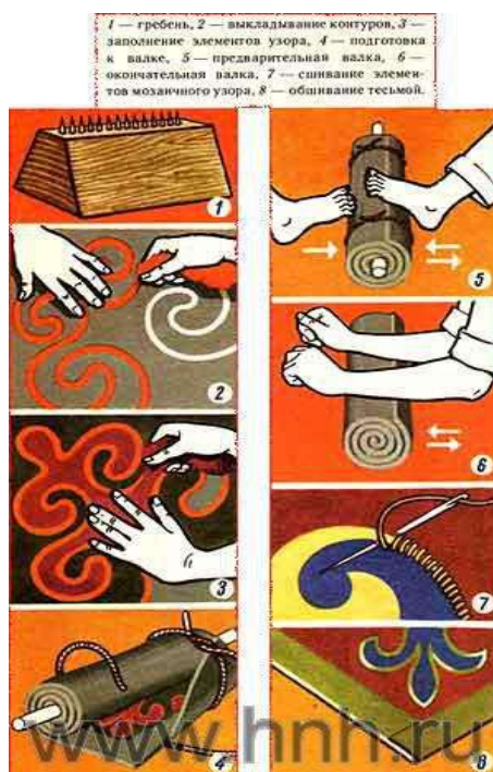
Рис.4. Этапы войлочного производства ручным способом
